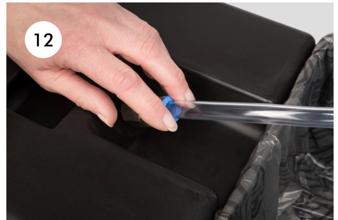
12. Ziehen Sie den Schlauch aus dem Schlauchanschluss, indem Sie den blauen Ring an der Oberkante des Schlauchanschlusses nach unten drücken.
