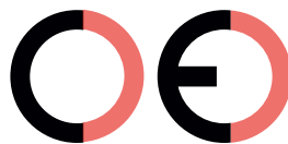
Falsche CE-Kennzeichnung (zu großer Zwischenraum)
