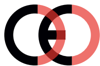
Falsche CE-Kennzeichnung (zu dicht)
